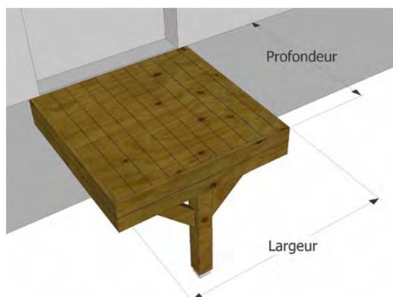
**Structure** en pin traité autoclave classe IV.
