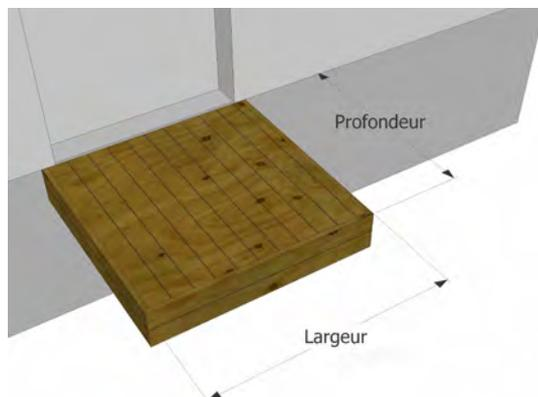
**Structure** en pin traité autoclave classe IV.
